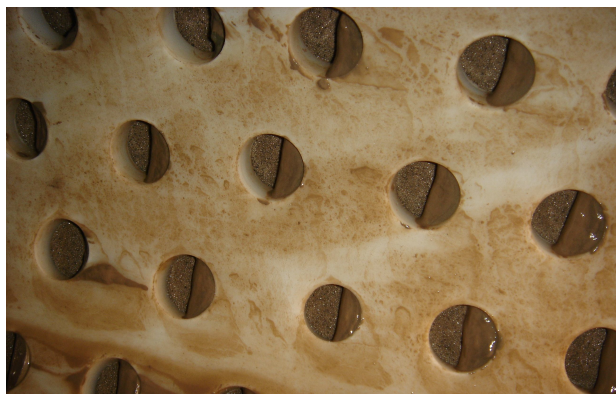
图 6 泡沫塑料过滤体上聚集的细砂颗粒
