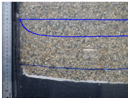
图 7 直线型铺膜锚固结构中典型土工膜变形模式照片
