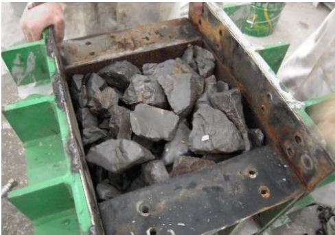
图 2 地层模拟平台充填照片
