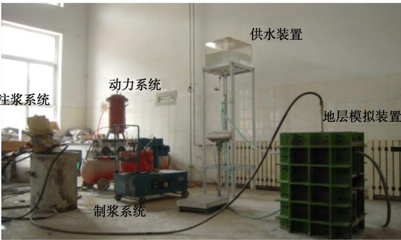
图 1 注浆模拟试验装置整体布置
