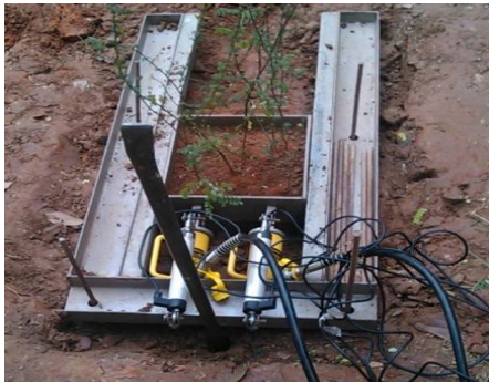
图 2 原位剪切试验 Fig. 2 In-situ shear tests
