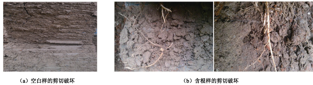
图 5 试样剪切破坏情况
