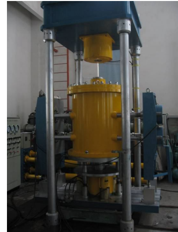
图 1 大型粗粒土真三轴仪
