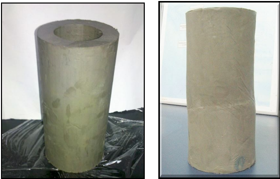
图 3 制备完成和剪切结束时的试样 Fig. 3 Hollow cylinder clay specimens
