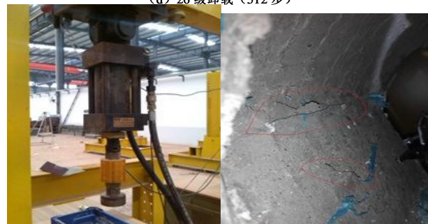
(e) 物理模型试验洞室加载系统和围岩裂缝
