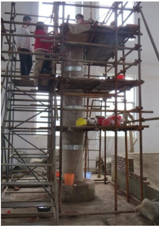
图 5 大型室内降雨入渗模型
