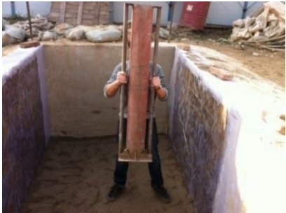
图 1 试验模型及填土夯实
