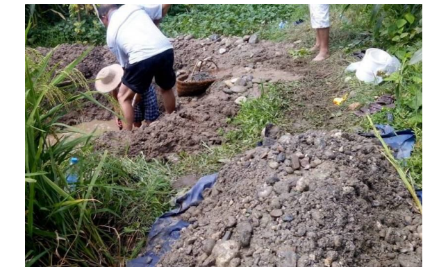
图 3 松柏村液化场地人工探坑取样 Fig. 3 Specimens collected from liquefied layer
