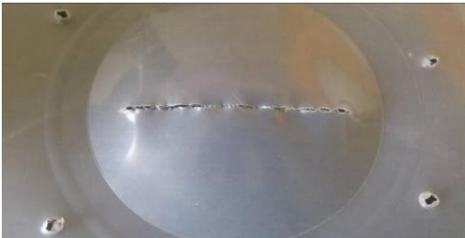
图 4 土工膜试样典型胀破形态
