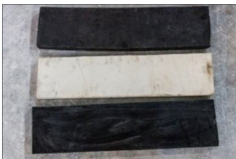
(b) 3 种垫层 (从上到下 EPDM、PU 和 HNBR)
