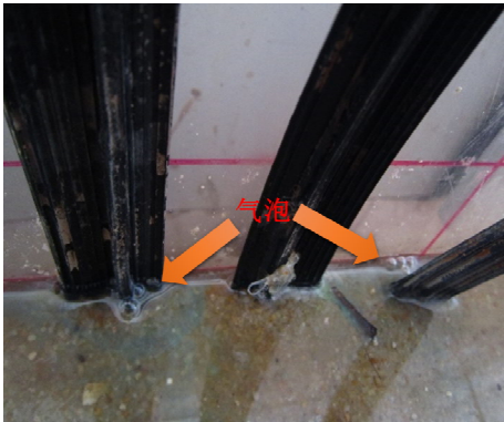
图 6 电解饱和砂土地基产生气泡的现象 Fig. 6 Phenomena of electrolytic tests
