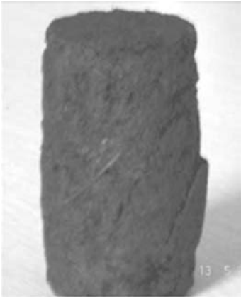
图 8 吉林草炭土的破坏模式 Fig. 8 Failure mode of turf soil in Jilin Province
