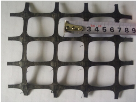
图 2 试验用土工格栅
