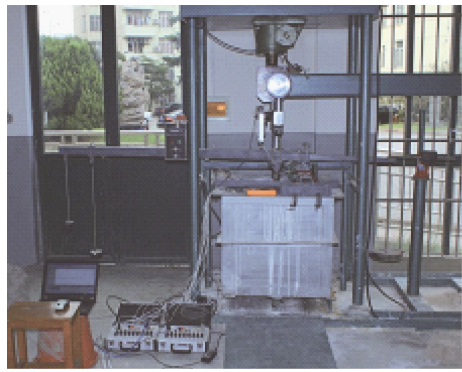
图 12 模型桩加载测试 Fig. 12 Photo of the model test
