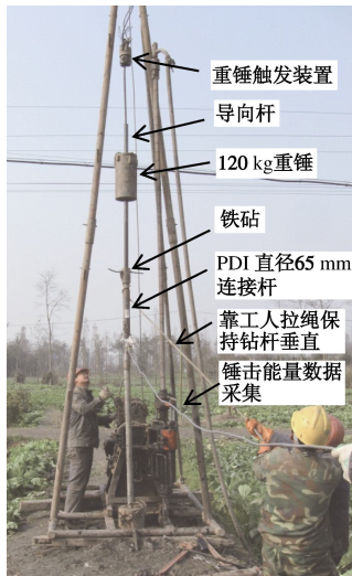
图 2 中国超重型动力触探重锤传递能量测试
