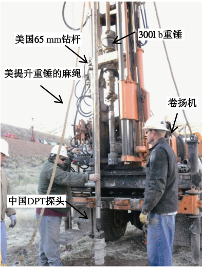
图 8 中国超重型动力触探在美国 Echo dam 推广试验 Fig. 8 China's DPT tested at Echo dam gravelly soils site in U.S.
