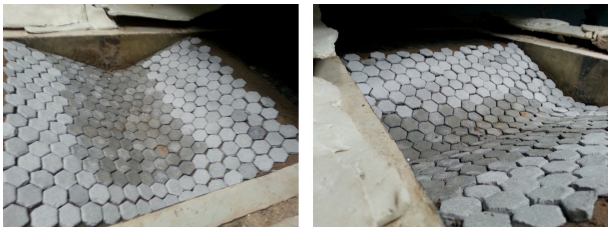
图 7 缩尺的衬砌板模型
