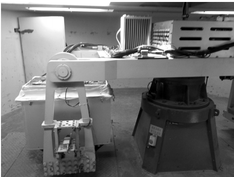
图 4 冻融离心模型装置实物图
