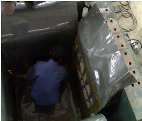
图 11 模型边界青稞纸减摩处理法
