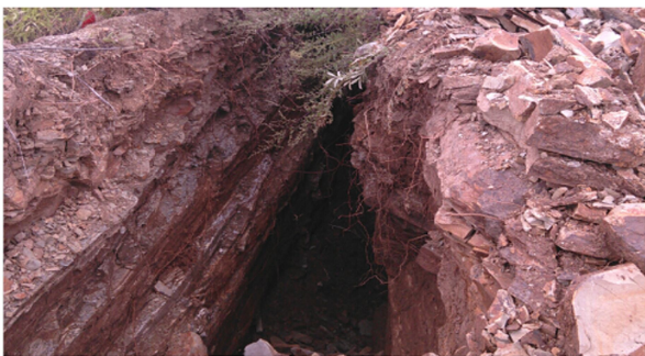
图 2 K72+550 段 J_2 结构面出露图
