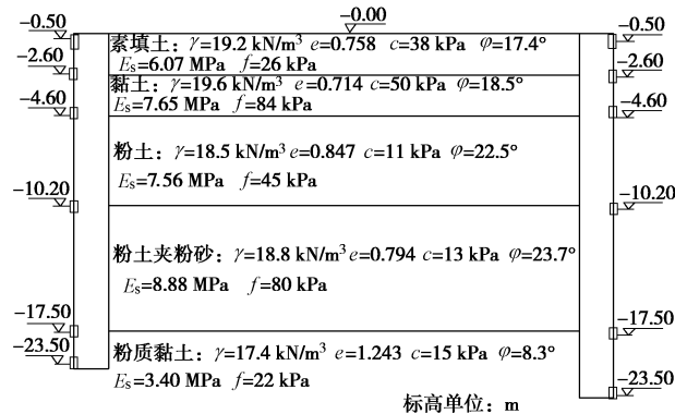
图 2 地质条件及钢筋计布置图
