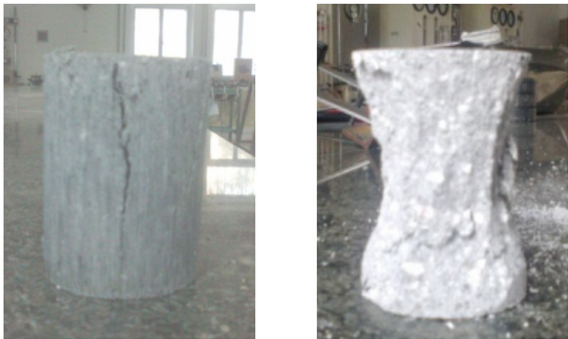
(a) 首先出现竖向裂缝 (b) 最终呈对顶的圆锥形
