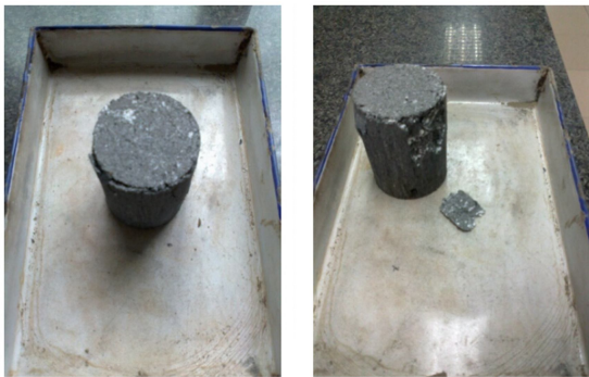
(a) 养护7 d (受压后) (b) 养护28 d (受压后) 图 1 石灰炉渣化学作用在试件表面形成的硬壳层
