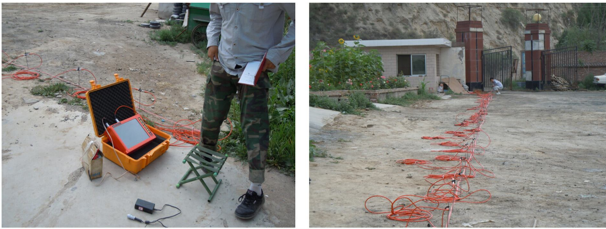
图 11 现场电阻率测试布置图 (台阶 1)
