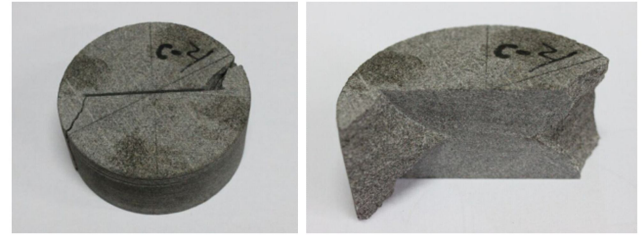
图 10 CCNBD 复合型断裂试验破坏结果 ( \beta=28^\circ )
