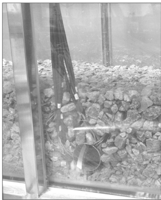
图 7 试验中的管道及碎石保护结构 Fig. 7 Pipe and rock armor berm in tests
