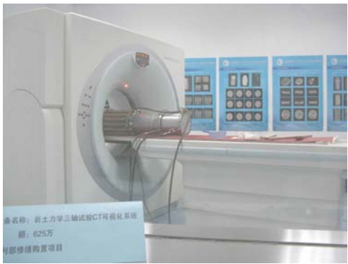
图 1 岩土力学三轴试验 CT 可视化系统
