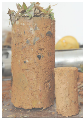
图 1 原状草根加筋土试样
