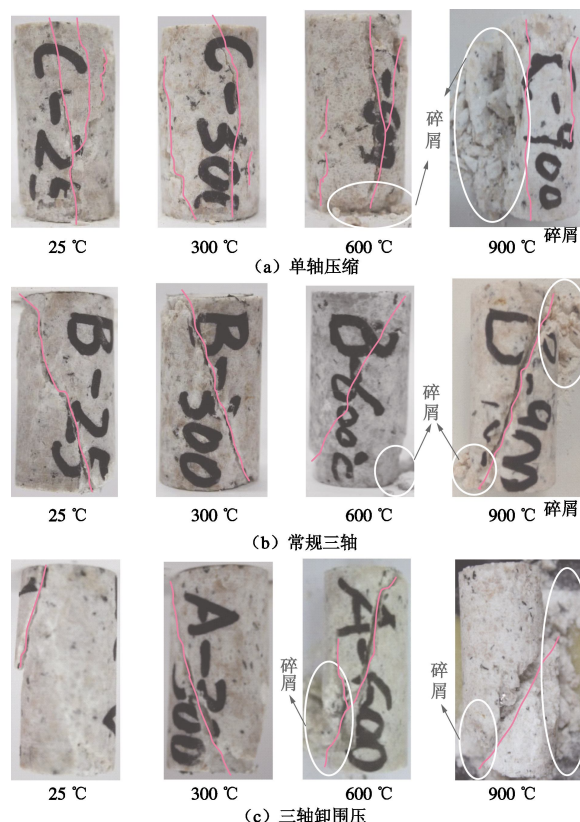
图10 高温后花岗岩在不同应力路径下的破坏形态对比(从左到右依次为25℃, 300℃, 600℃, 900℃)
