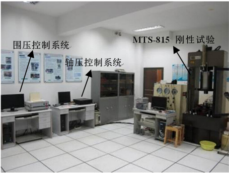
图 7 MTS-815 型岩石测试系统 Fig. 7 MTS-815 rock testing system
