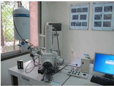
图 8 S-3000 N 型扫描电镜 Fig. 8 S-3000 N scanning electron microscope
