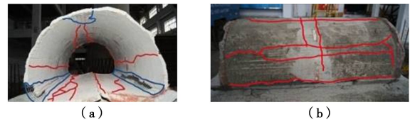
图 11 跨断层 C 段衬砌裂缝形态
