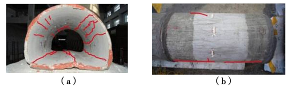
图 12 设置减震层后 C 段衬砌裂缝形态
