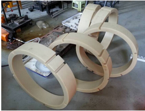
图 10 外侧开槽的模型管片环
