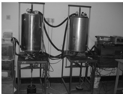
图 2 恒温冷浴土壤试验系统
