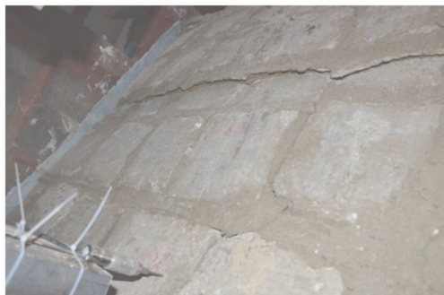
(a) 坡体中上部出现小幅度层间错动
