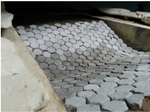
图 5 在模型箱内制作好的渠道模型 Fig. 5 Finished channel model
