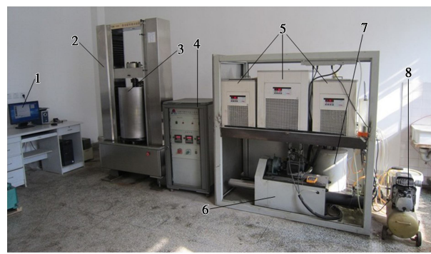
1- 计算机; 2- 台架; 3- 压力室; 4- 控制柜; 5- 冷浴; 6- 围压加载装置; 7- 储油罐; 8- 气泵
