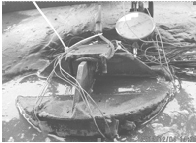
图 7 水平荷载下吸力式沉箱基础破坏图
