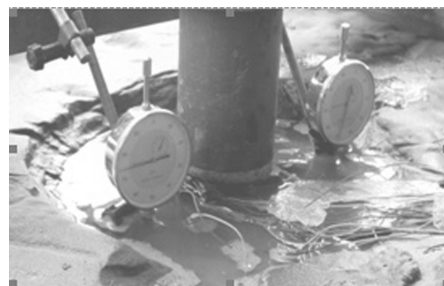
图 3 竖向荷载下吸力式沉箱基础破坏图
