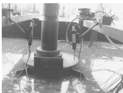
(b) 吸力式沉箱基础的竖向加载试验 图 2 试验照片
