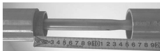
(b) 拉压耦合大变形锚杆试件
