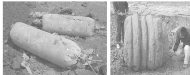
图 2 承压型囊式扩体锚杆的开挖检验工程照片
