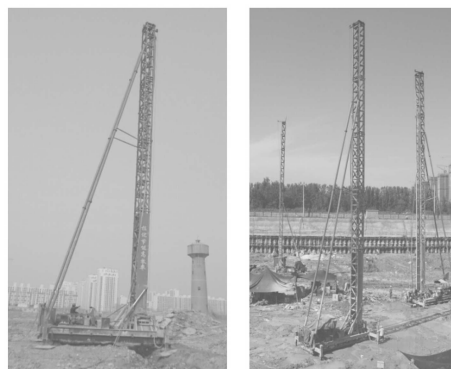
图 6 塔式旋喷扩体锚杆钻机装备
