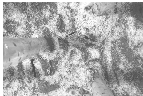
图 5 电渗-堆载试验裂缝开展情况
