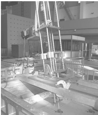
图 5 压桩装置 Fig. 5 Devices for pile driving
