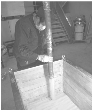
图 4 落雨法制备砂土 Fig. 4 Preparation of sand
