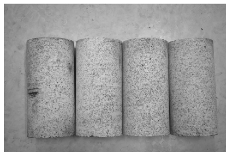
图1 加工完成的岩石试样
