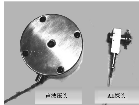
图 3 声波压头和 AE 探头实物图
