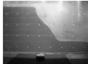
图 7 边坡破坏后的最终形态及其滑面位置
