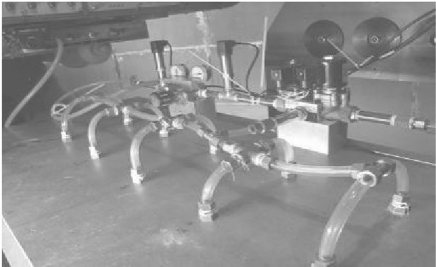
图 1 降雨模拟装置实物图
