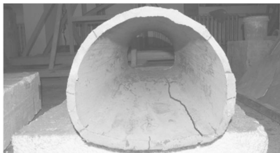
图 10 第一组试验 A 段衬砌裂纹(内套管)
