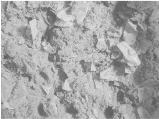
图 9 塑料膜与砂均匀混合后的试样
