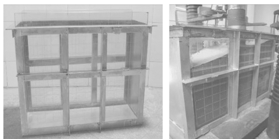
图 1 模型槽及试验土料装铺图
