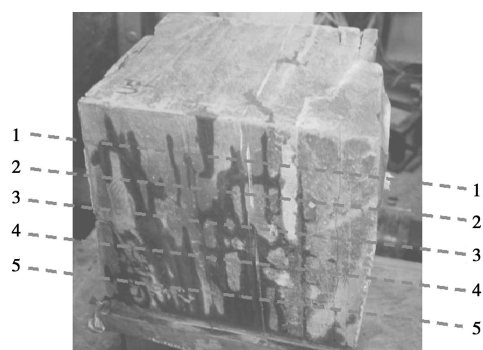
图 12 水力压裂后裂缝分布的直观效果图
