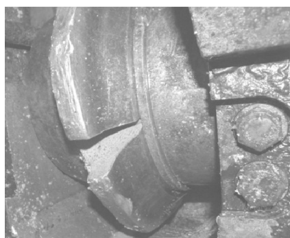
图8 滚刀刀圈崩裂
