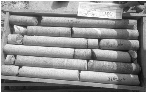
图 3 基岩未处理前取芯岩样图 Fig. 3 Rock samples before blasting
