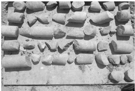
图 4 基岩爆破后取芯岩样 Fig. 4 Rock samples after blasting
