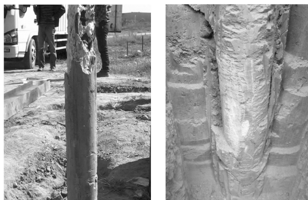
(a) 高聚物锚固体拔出
