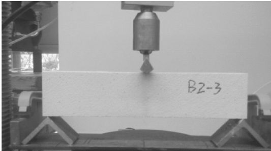
图 2 非贯通层面 I 型断裂韧度测试 Fig. 2 Mode I fracture toughness test for intermittent rock plane 1.3 正交次级节理制作
