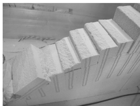
图 19 Topple_2 边坡贯通破坏面
