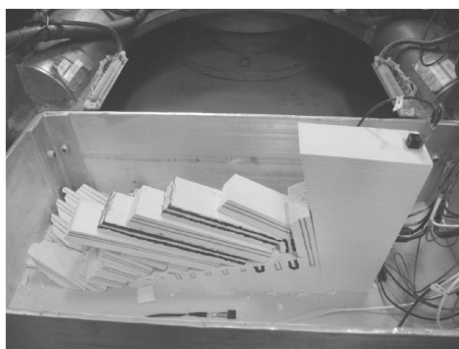
图 16 Topple_1 边坡动力破坏形态
