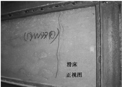
图 11 地震后模型侧面破坏状态图(1.0g)
