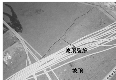
图 10 锚杆支护侧模型坡顶破坏状态图(0.9g)
