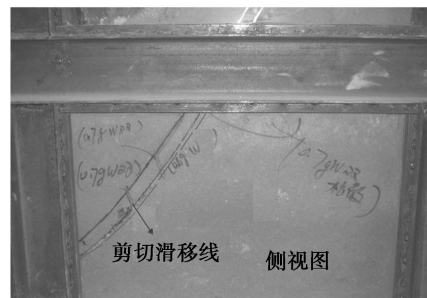
图 9 无锚杆支护侧破坏状态图 (0.7g)
