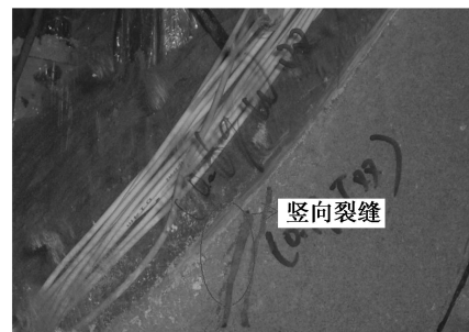
图 8 无锚杆支护侧破坏状态图(0.6g)
